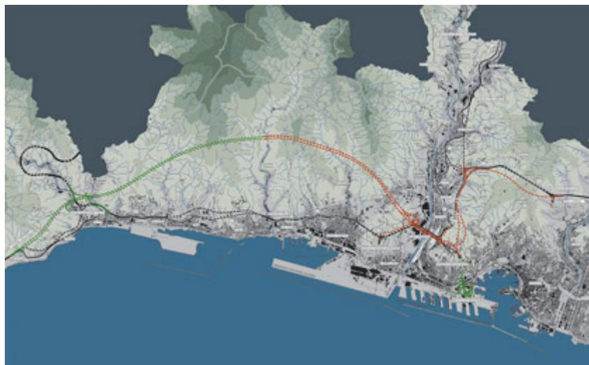
È identica al tracciato 4, salvo che il nuovo ponte, di 1120 m, in sostituzione del ponte Morandi, viene costruito immediatamente a lato mare dell'attuale ponte.
